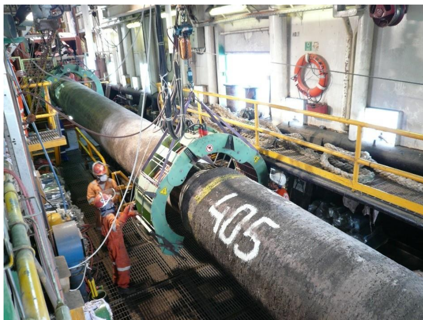
Индукционные катушки для проекта по морским объектам для J-образной укладки труб.
