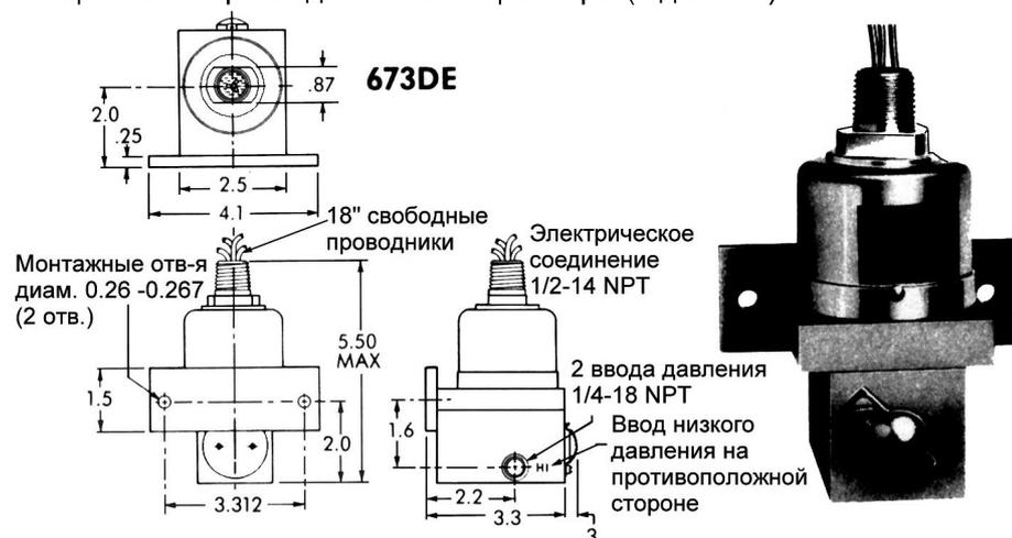
Реле разности давлений с диапазоном контролируемых разностей давлений от 0,14 до 4,14 бар
