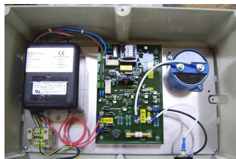
Преобразователь розжига в корпусе для общепромышленного применения.
