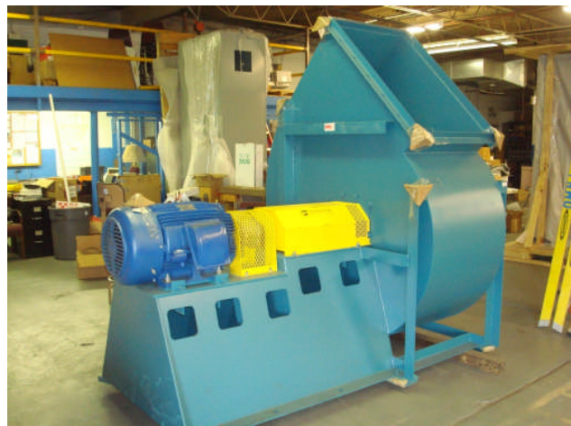
Фото 5. Центробежная воздуходувка перед отгрузкой клиенту.
