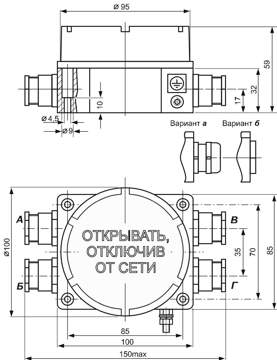
Основной вид – соединительная коробка с кабельными вводами для взрывозащиты вида «д».
