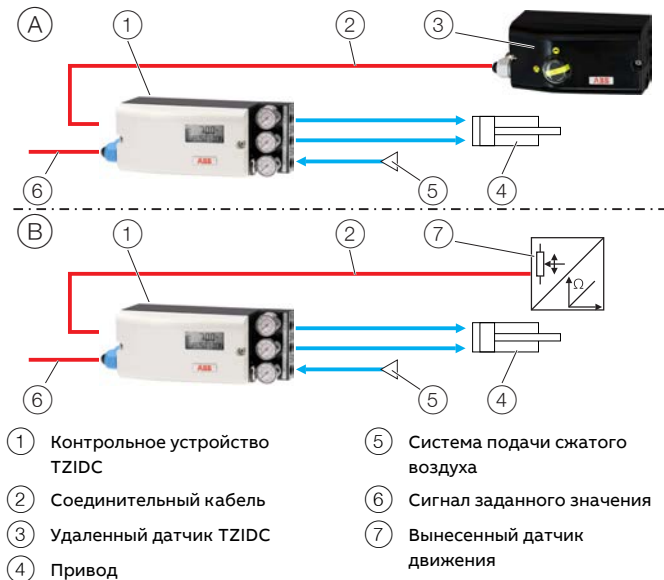
Рис. 3: TZIDC с внешними датчиками движения
